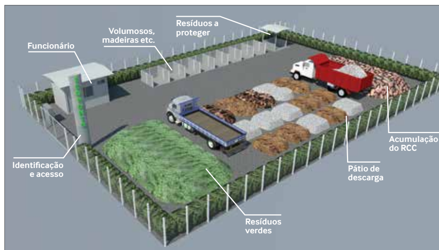
Figura 3 – Desenho ilustrativo do Ecoponto Simplificado – área em torno de 1.000m 2 para manejo do RCC com equipamento de carga
